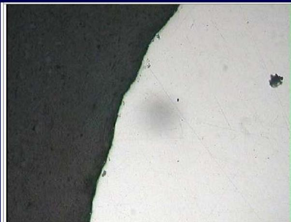
Fig. 5: Vergella – sezione trasversale – descagliatura meccanica (100x)
