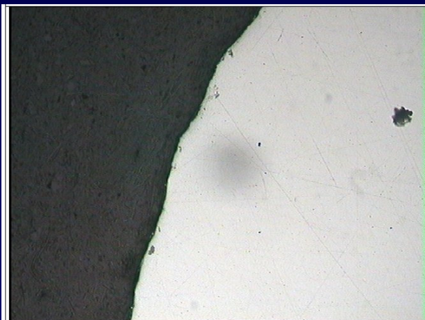
Fig. 5: Vergella – sezione trasversale – descagliatura meccanica (100x)
