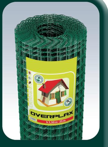
Red de alambre galvanizado, electro-soldada y plastificada, con un triple borde ondulado en las extremidades y puntas en la parte superior. Los alambres verticales (lineales) y horizontales (ondulados) de las mallas electro-soldadas se realizan en acero galvanizado. El recubrimiento plástico se obtiene mediante el proceso de sinterización exclusivo "Galvaplax Process". Su uso está destinado principalmente al cercado de áreas residenciales, industriales y deportivas.
